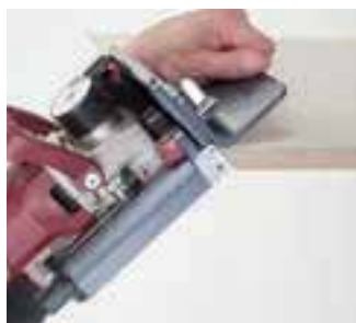
Exterior flush mitre joints
